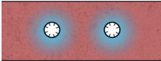
Prinzip der Nachtauskühlung mit integrierten Lüftungsleitungen
