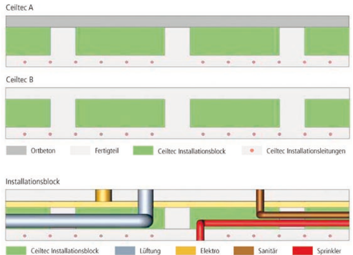
Cross-section of a Ceiltec A and Ceiltec B floor made of sandwich layers in the form of ribbed slabs together with integrated ducts Querschnitte einer Ceiltec A und Ceiltec B Decke aus Sandwichschalen in Form von Rippenplatten, samt integrierter Leitungen
