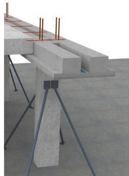
Bild 4: Der selbsttragende Fertigteilträger mit speziell geformtem Querschnitt wird im Bauzustand auf der Stütze gelagert.
