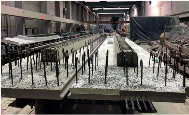
Weit spannende vorgespannte Rippenplatte für eine Deckenplatte mit Sandwichquerschnitt zur Gewichtsreduzierung
