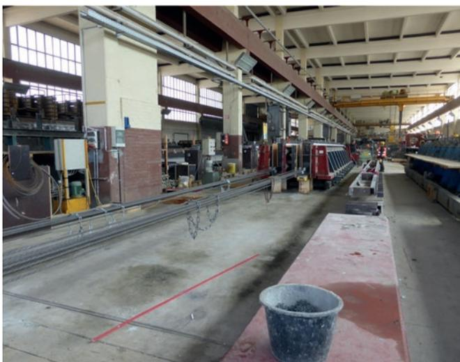
*Klassisches Spannbett für Fertigteilverke zur Produktion von Unterzügen auf einer langen Spannbahn*
