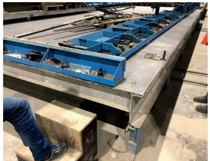
*Typischer Fertigungstisch aus einer Umlaufanlage als Grundlage für ein mobiles Spannbett*
