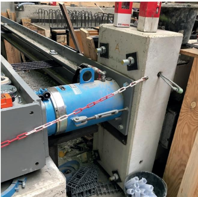
Senkrechter Auflagerbalken zur Lastverteilung auf die beiden am Schaltsch montierten Längsbalken und zur Befestigung der Zylinder
