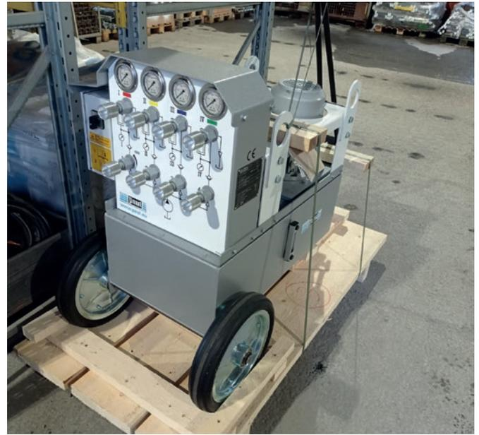
Steuereinheit zum individuellen Ablassen der vier Hydraulikzylinder
