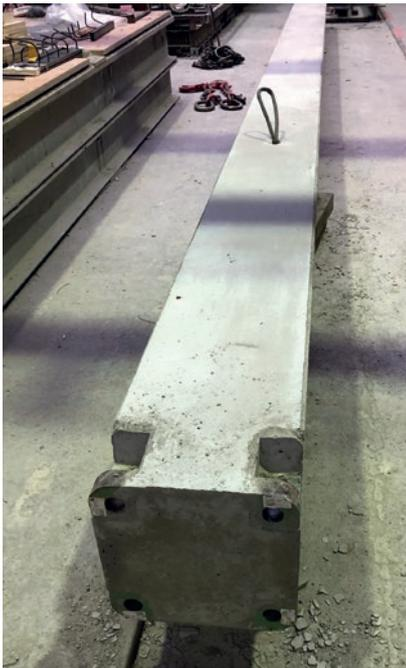
Vorgefertigte Druckbalken mit der Möglichkeit zur Verlängerung durch Koppelung mit Gewindestangen
