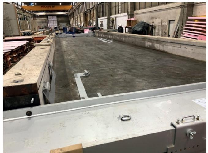
Variante für ein mobiles Spannbett mit einer dünnen Betonplatte zur Aufnahme von Druckkräften inkl. der eingelegten Stahlplatte und der seitlich verbundenen Balken
