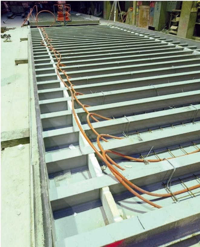
*Einbau von Rohrleitungen und von Beton als Wärmespeicher zwischen den vorhandenen Tragrippen des klassischen Schaltischs*
