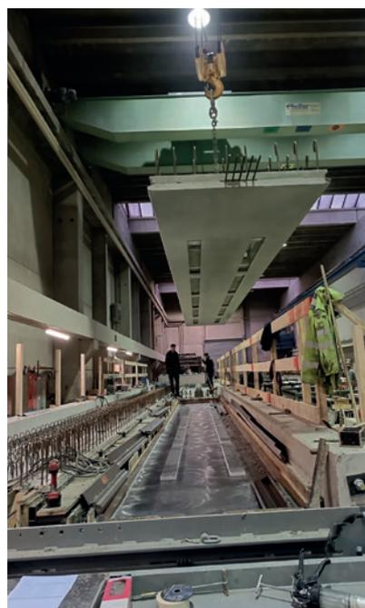
Tägliche Belegung des Schal-tischs mit mo-bilem Spann-bett für die Produktion von verschiedenen in Form und Ab-messung un-ter-schiedlichen vorgefertigten Bauteilen
