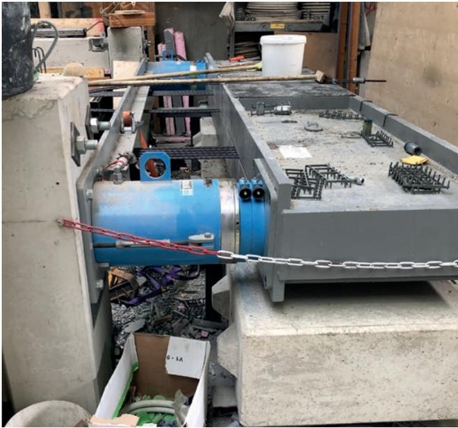
Hydraulikzylinder mit Distanzringen zum Entspannen der Kraft an den Litzen, um die Verformungen gezielt zu steuern
