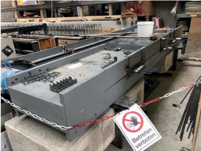
Spannjoch mit dem durchgehenden Schlitz für die individuelle Verankerung der einzelnen Litzen
