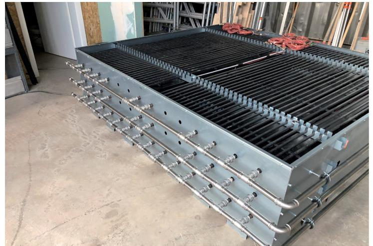
Bild.03: Aufbau der Einbauteile für das Fundament der Energiesäule
