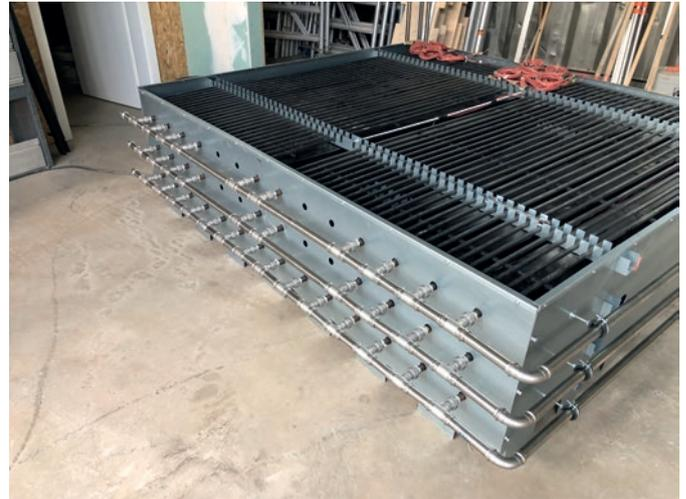
**Bild 2** Mit PCM gefüllte Behältnisse als Einbauteile für Betonelemente
