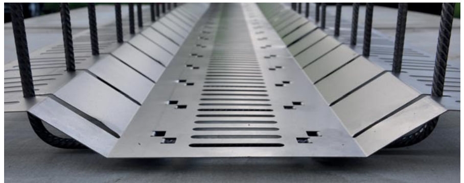
Bügelchablone: für die Ausrichtung der Bügelreihen im Gurtstreifen inklusive der Vertiefung für den späteren Einbau der Längsbewehrung
