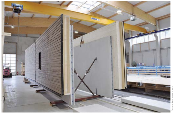
Bild 4 Werkseitige Herstellung der Hybridwand in Holz-Beton-Verbund
